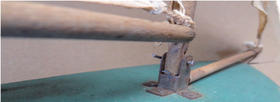
Piètement articulé de mât pour voilier jouet mis au point par Ed. Desvaux à partir de 1903
