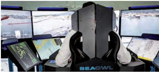
Passerelle virtuelle installée à l'École polytechnique pour la conduite à distance du VN Rebel à Toulon en septembre 2020 (© École polytechnique)
