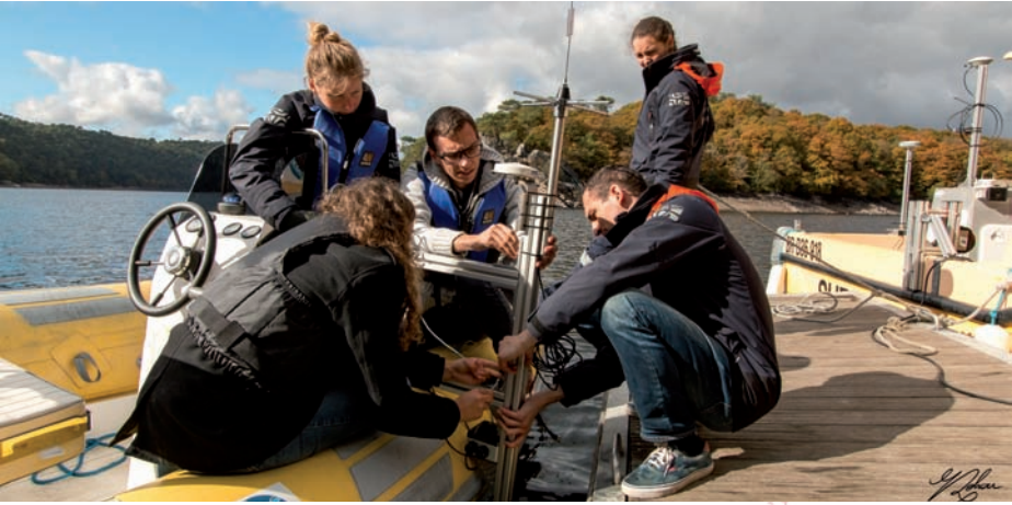
Les élève ingénieurs en hydrographie installent un sondeur mono-faisceau pour la cartographie du lac de Guerlédan.
